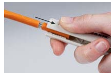
Das Kabel kann nun leicht abgeknickt werden. Dann lässt sich der Mantel nach hinten abstreifen.
