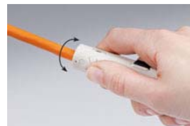
Die Verriegelung wird gelöst und das Kabel in Messerpaar 1 eingelegt.
